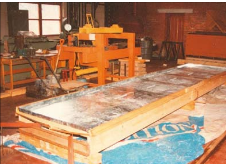
Joonis 6. Spetsiaallogaplaatidest sidemetega puit-betoonpaneeli katsetamine TTÜ laboris.
